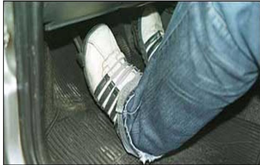
**Descansar o pé sobre o pedal da embreagem é um vício que provoca o desgaste prematuro dos componentes do sistema**
