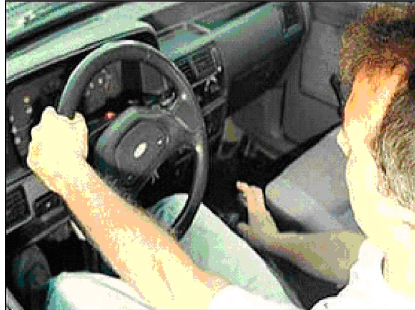
Dirigir com a mão apoiada sobre o câmbio força o trambulador e seus terminais, provocando desgaste prematuro.
