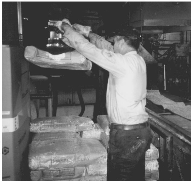
Figura 80.10 • Un elevador por vacío coloca las bolsas en el transportador de carga de un malaxador Banbury, evitando el dolor de espalda causado por la manipulación manual.
