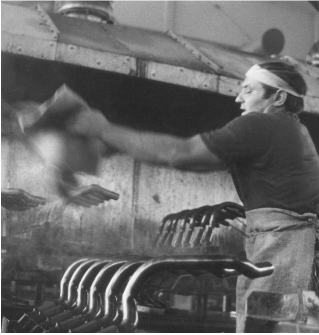
Figura 80.11 • Una campana de aspiración controla los humos producidos durante el acabado de un tubo en una fábrica industrial de caucho en Italia.
