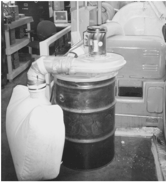
Figura 80.9 • Un colector de polvo de una muela abrasiva recoge el polvo de caucho.
