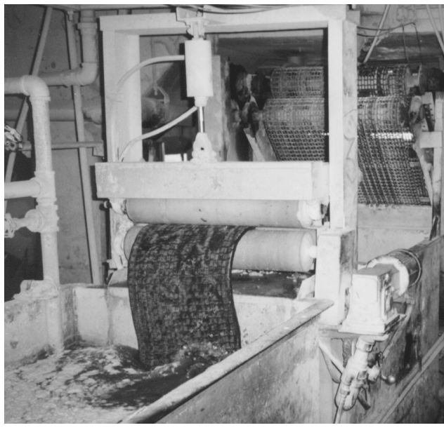
Figura 80.14 • Una plancha de caucho procedente de un laminador Banbury pasa por un baño de agua donde se le aplica un compuesto antiadherente.
