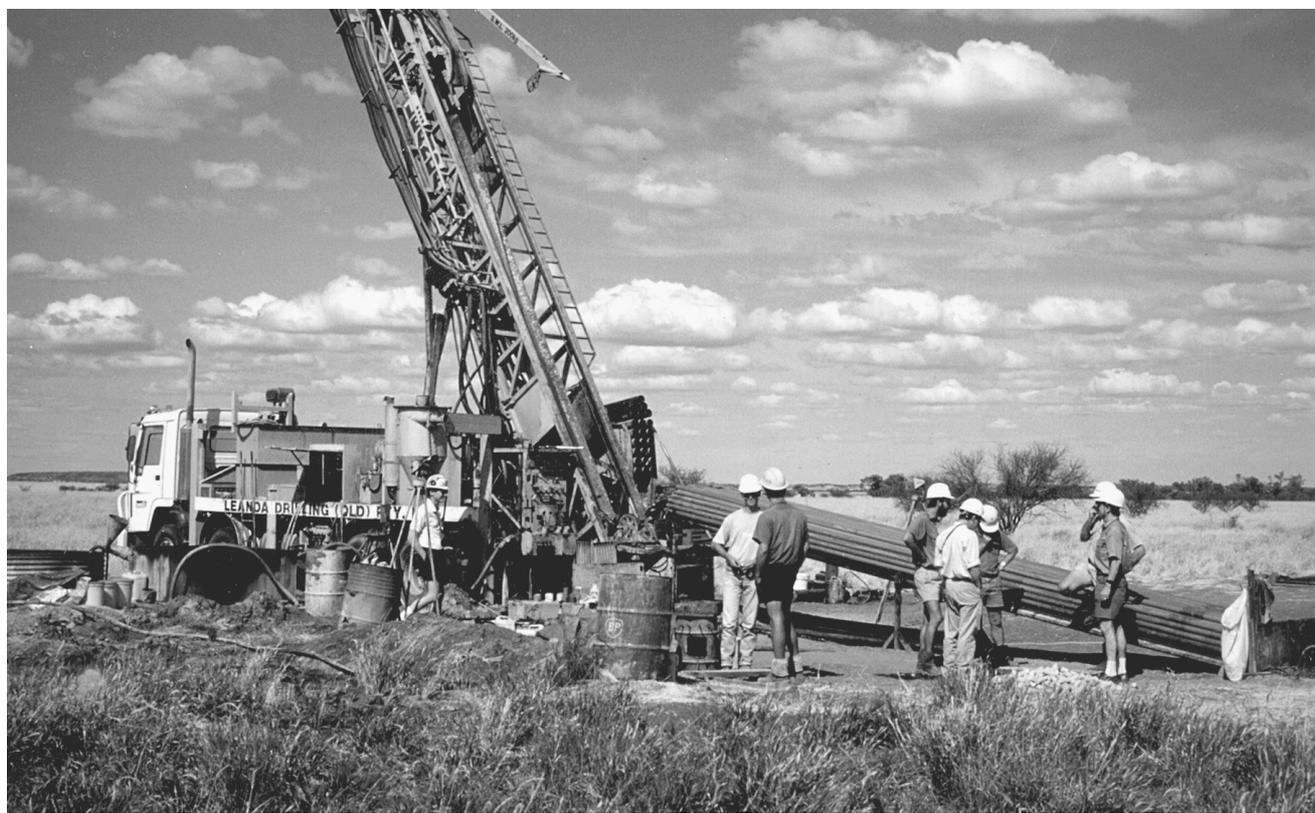
Figura 74.6 • Perforación de circulación inversa en un lago helado de Canadá.
