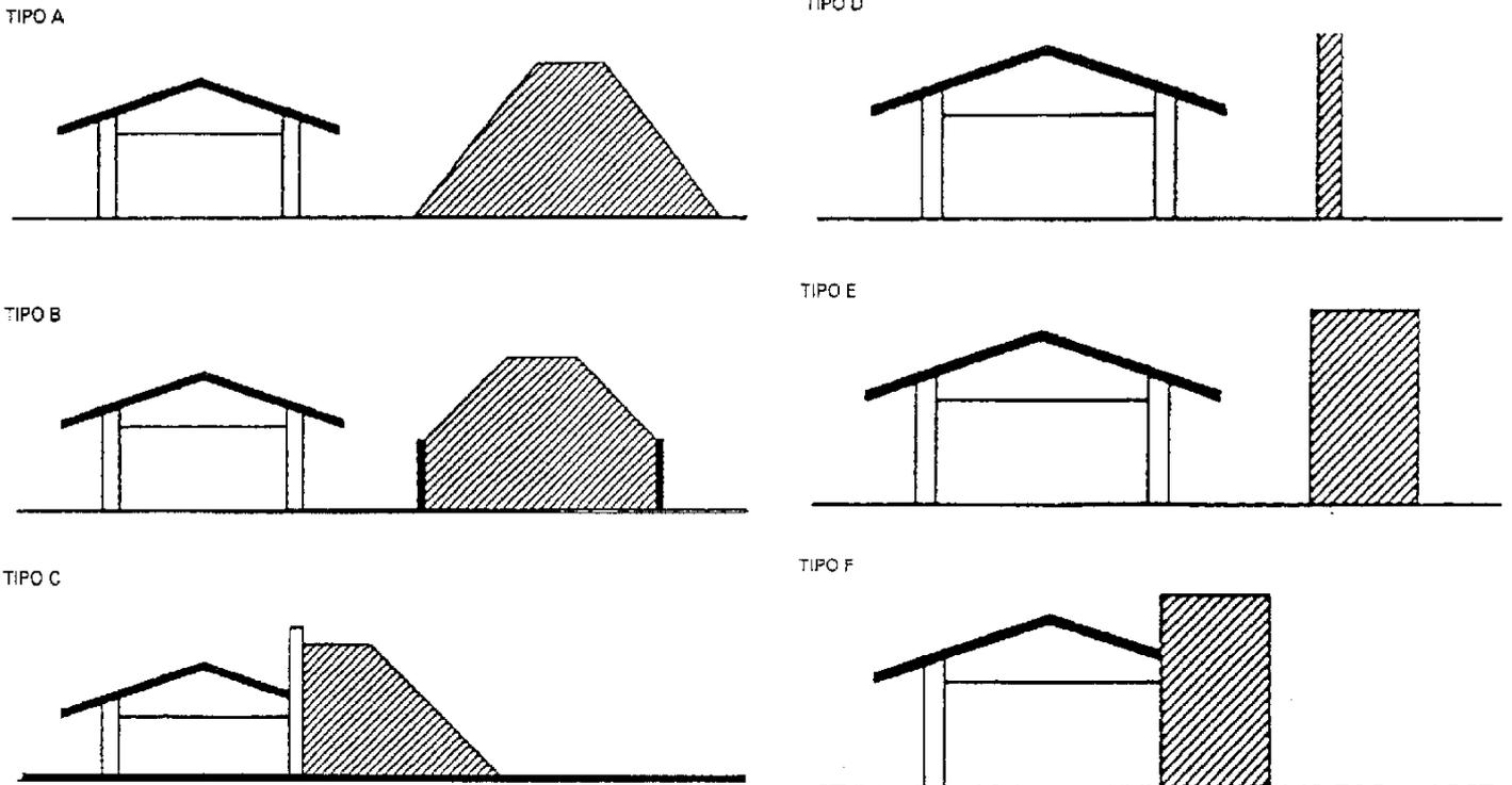
Los muros deben estar calculados para resistir, sin vuelco, el efecto de la onda de choque.
