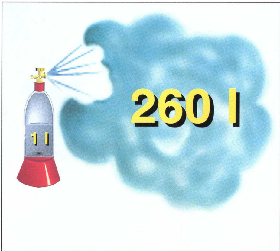
Figura 10: Aumento de volumen del propano durante la vaporización
