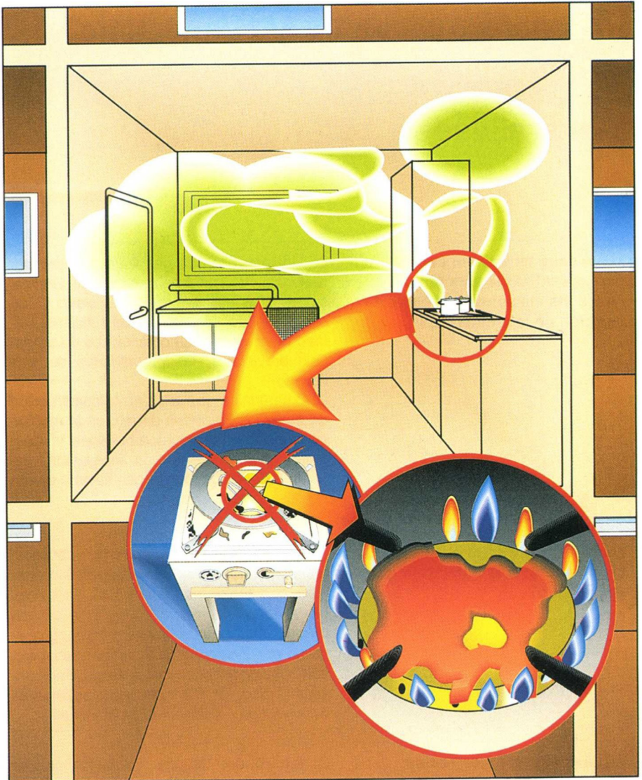
Figura 17: Formación de CO como consecuencia de la utilización de un quemador sucio
