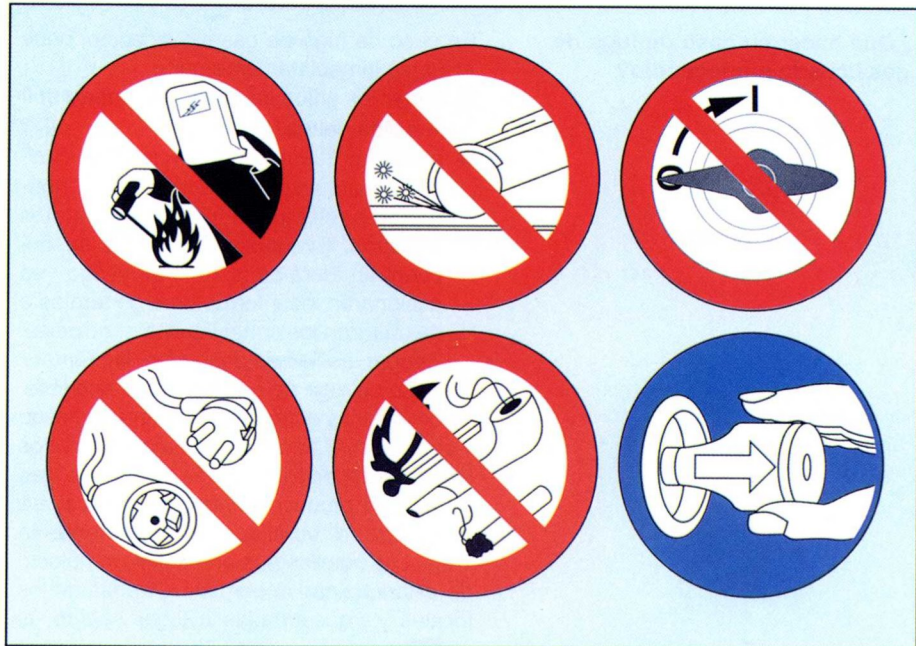
Figura 45: Eliminar fuentes de ignición en caso de fuga de gas
