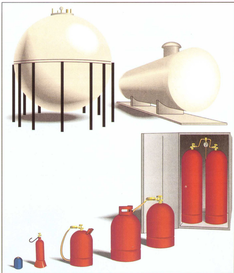
Figura 4: Instalaciones abastecedoras de gas licuado
