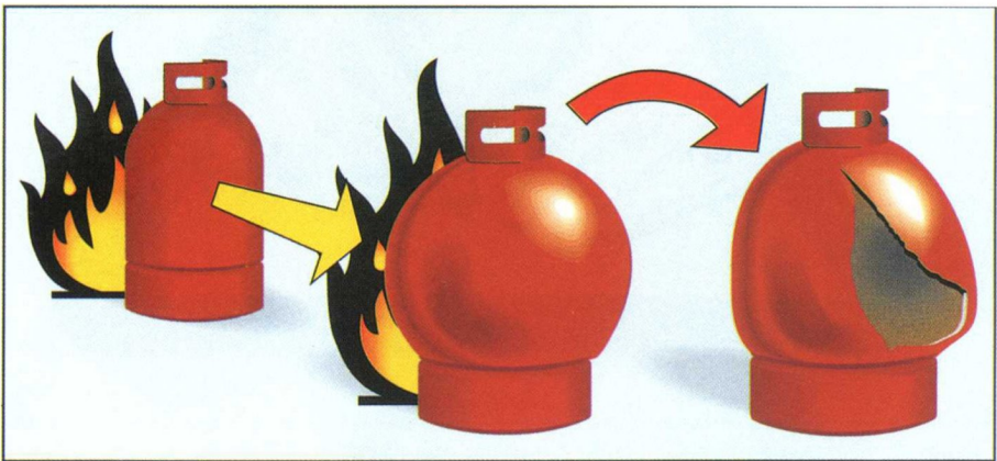
Figura 12: Efecto de las llamas sobre una botella de gas licuado
