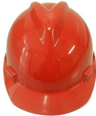
**CAPACETE** - dispositivo básico de segurança em qualquer obra. O casco é feito de material plástico rígido, de alta resistência à penetração e impacto. É desenhado para rebater o material em queda para o lado, evitando lesões no pescoço do trabalhador. É utilizado com suspensão, que permite o ajuste mais exato à cabeça e amortece os impactos.
