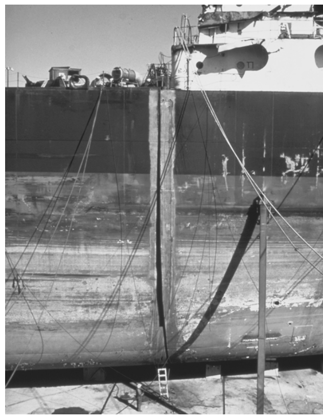
Figura 92.11 • Corte por la mitad de un buque para añadir una nueva sección.
