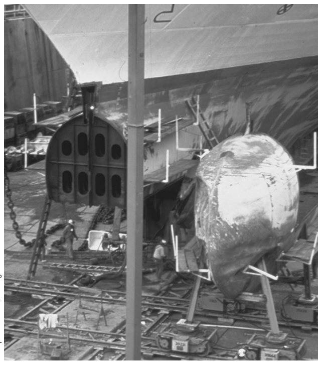
Figura 92.12 • Sustitución de la proa de un barco accidentado.
