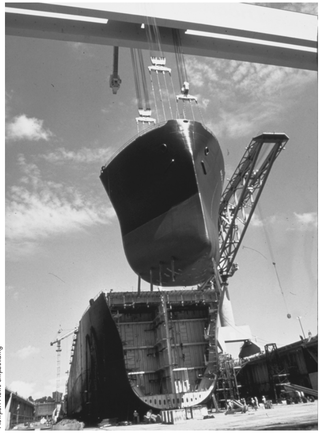
Figura 92.8 • Montaje de la proa en el casco de un buque.
