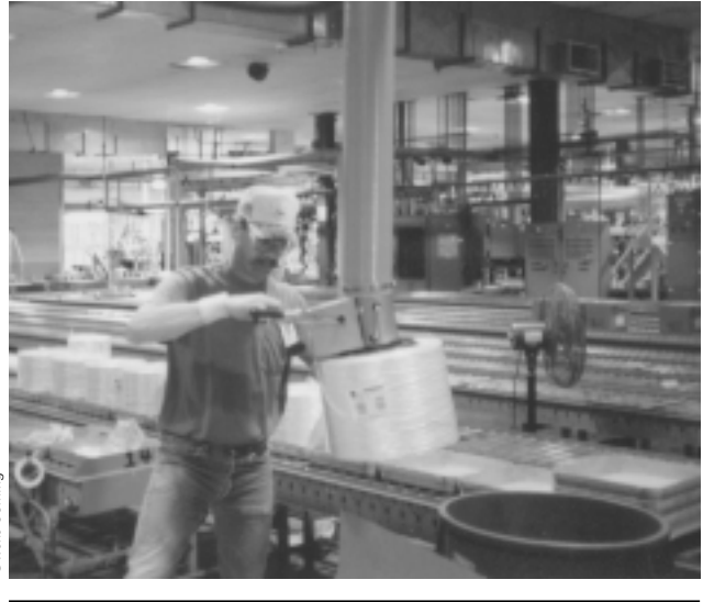
Figura 84.2 • Utilización del elevador de vacío para la manipulación de paquetes de 20 a 35 kilos de vidrio textil.
