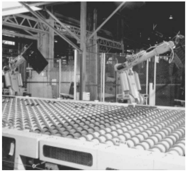
Figura 84.3 • Los robots utilizados en la manipulación de luna pulida reducen los riesgos de heridas y ergonómicos.
