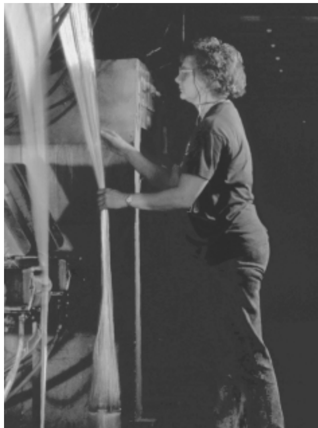
Figura 84.11 • Filamentos de vidrio textil en el momento de ser extraídos de la hilera. Los filamentos se reúnen en manojos y se enrollan en fardos para el procesado.
