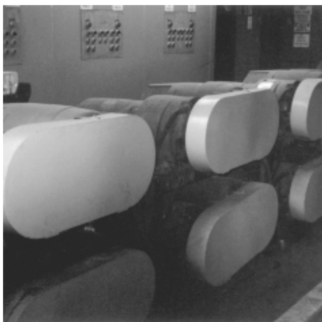
Figura 84.20 • Los dispositivos de protección de la maquinaria evitan que los operarios sufran accidentes por contacto con ejes giratorios, correas y cadenas de transmisión.
