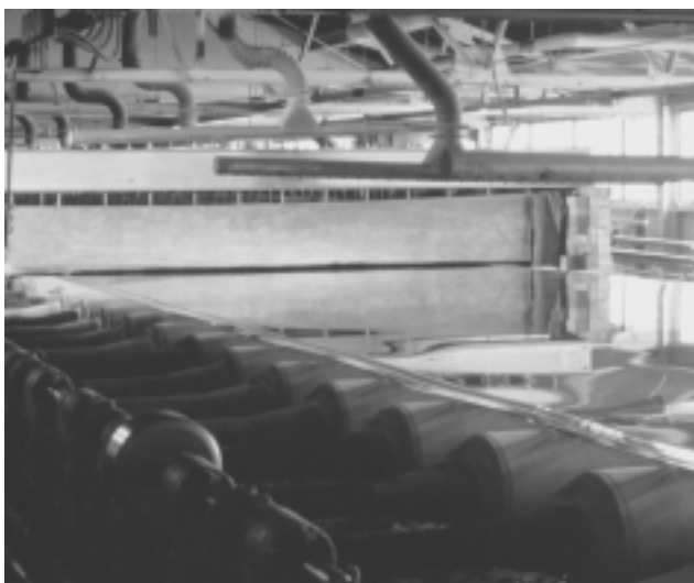
Figura 84.8 • Cinta de vidrio flotado saliendo del túnel de recocido.
