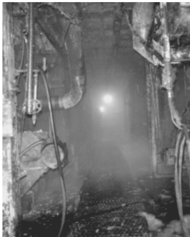
Figura 84.27 • Los aerosoles de agua de condensación reutilizada que no es tratada pueden provocar enfermedades por las materias en suspensión en el agua.
