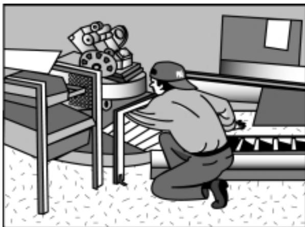
Un bloque motor es transportado en un transportador con mesas giratorias a dos niveles. El bloque es sujetado por cintas situadas en el nivel superior y las cintas se devuelven, vacías, al nivel inferior. El transportador se detiene de repente. Un mantador ve que uno de los cintas de retorno ha quedado atascado de nuevo en la mesa giratoria. Cuando alcanza la mesa y tira del bloque motor se activa un sensor. La mesa giratoria comienza a girar y le atrapa la mano. (Ilustrador: Tomas Karlsson).
