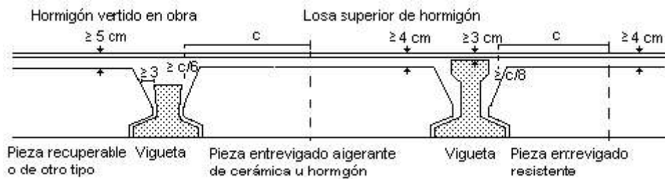
Figura 4.1.a Condiciones geométricas de los forjados
